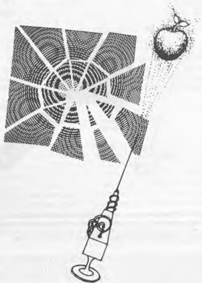
Figura 2 — Diferentemente das fotografias normais, cada parte de uma peça do filme holográfico contém toda a informação do conjunto. Assim, se uma placa holográfica é quebrada em fragmentos cada peça pode ser ainda usada para reconstruir a imagem inteira.
