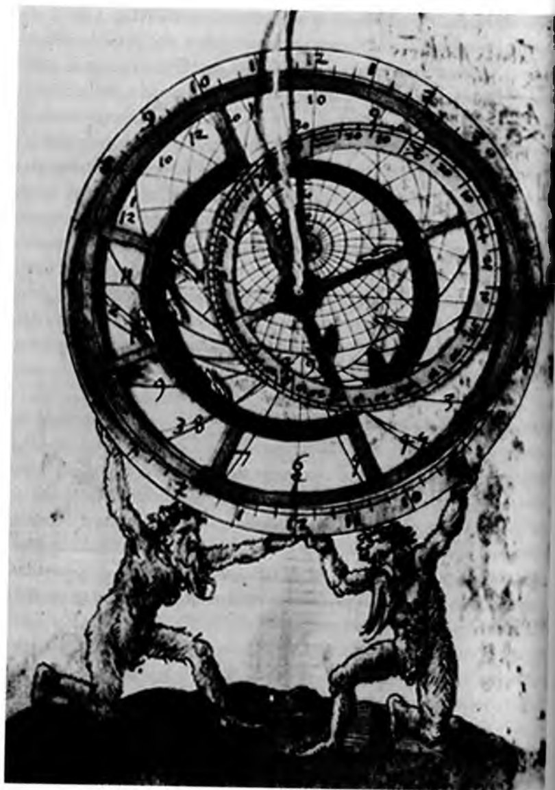
Fig. 6: Astrolábio do livro colegial de Sebastian Münster, 1515-18. A placa gnomônica (um disco aberto com a projeção do zodíaco) é de papel, um fio serve de ostensor (mostrador).
